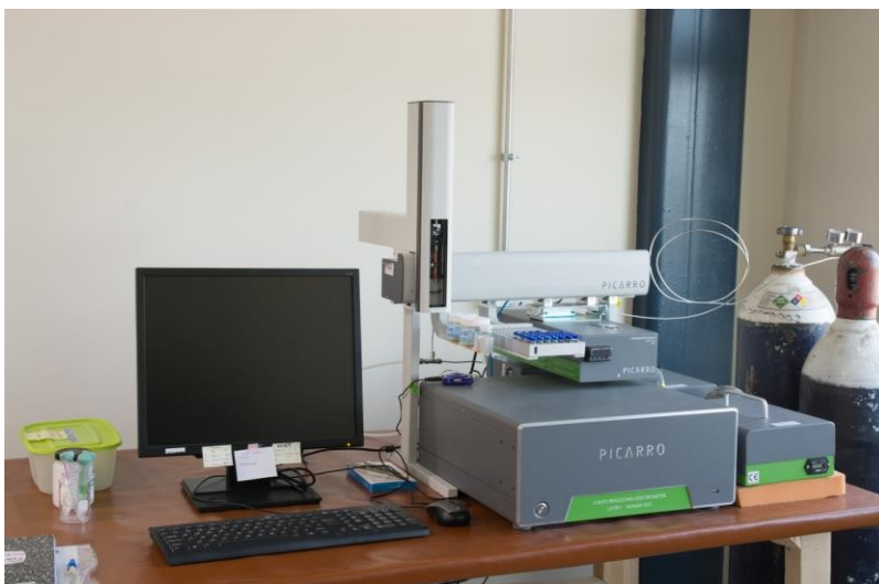
Fig. 1. Analizador de isótopos de agua de alta precisión \delta^{18}\text{O} y \delta\text{D} . Picarro Inc., modelo L2130- i .
